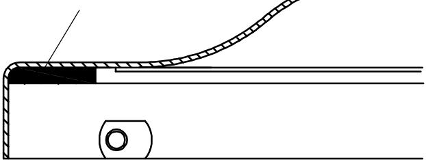
**Drum Cover Seal Installation****Instalación del Sello de la Cubierta del Tambor****Application du composé d'étanchéité au couvercle du tambour**
