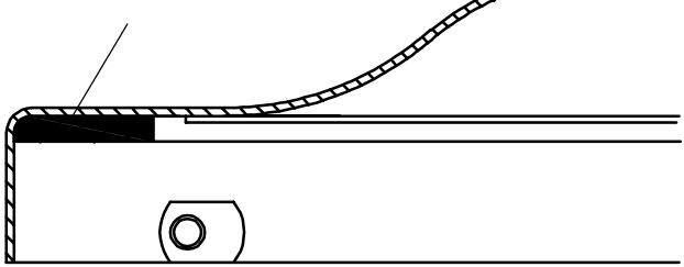
**Drum Cover Seal Installation****Instalación del Sello de la Cubierta del Tambor****Application du composé d'étanchéité au couvercle du tambour**
