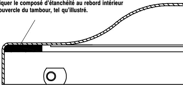
**Drum Cover Seal Installation****Instalación del Sello de la Cubierta del Tambor****Application du composé d'étanchéité au couvercle du tambour**
